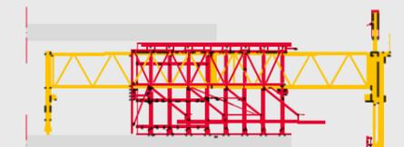
Die Innenschalung fährt auf dem Transportträger in den nächsten Abschnitt. Bei hochgezogener Mittelunterstützung wird die Innenschalung über den Transportträger ausgeschalt.
