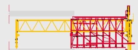
Die Innenschalung wird eingeschalt. Einbau der Anker und Schließen der Stirnschalung. Die Mittelunterstützung bleibt solange hochgezogen, bis die Sohle betoniert ist.
