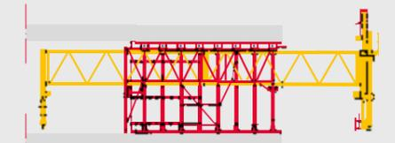
Umsetzen der Außenschalung mit Transportträger. Anker gelöst, Außenschalung ausgeschalt, vordere und hintere Abstützung hochgezogen.
