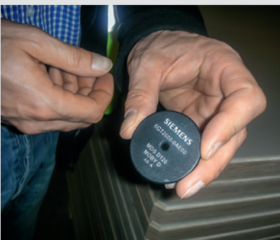
RFID Tags zum Einbau in die Unterlagsplatten: Die Tags haben eine feste einzigartige Nummer, über die das Brett eindeutig identifiziert werden kann.
